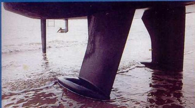
Les profils de quille et de bulbe sont soignés. Notez le décrochement dans le bord de fuite pour accroître la surface de portée.
