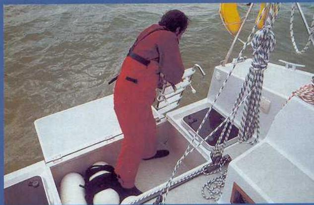
Haubané sur les prochains modèles, le capot du coffre de l'annexe servira de plateforme de débarquement et de bain.
